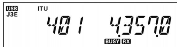
Для выбора морских каналов памяти также годятся кнопки микрофона **UP** и **DWN**. Нажимая их кратковременно, меняем значение канала ITU соответственно на шаг. Нажатие и удержание любой из этих кнопок на 1/2 секунды вызывает сканирование морских каналов памяти в выбранном направлении. Отпускание кнопки останавливает процесс сканирования.
