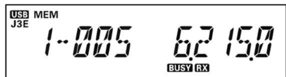
Для выбора каналов памяти также годятся кнопки микрофона **UP** и **DWN**. Нажимая их кратковременно, меняем значение канала соответственно на шаг. Нажатие и удержание любой из этих кнопок на 1/2 секунды вызывает сканирование каналов памяти в выбранном направлении. Отпускание кнопки останавливает процесс сканирования.
