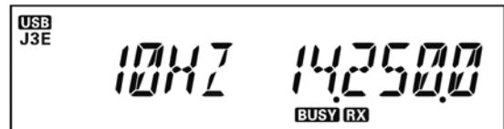
В морском режиме частота индицируется аналогично, но слева индицируется обозначение ITU текущего канала.
