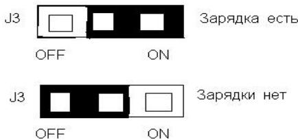
Если переключатель в положении включено (ON), зарядка аккумуляторов есть, но гальванические элементы в этом положении переключателя при внешнем питании могут перегреться и потечь, что испортит АА.
