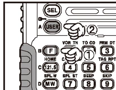
При включенном режиме блокировки можно получить доступ к Аварийному Каналу 121.5 МГц. Для этого нажмите однократно кнопку [121.5] (эта кнопка никогда не блокируется). Нажатие этой кнопки также разблокирует радиостанцию.
