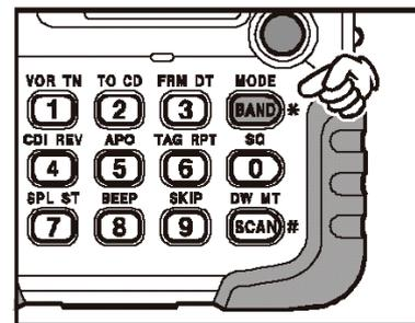
Прямой ввод частоты с клавиатуры – это самый простой способ настройки на рабочую частоту. Просто введите пять цифр частоты, для перехода на эту частоту.
